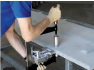
**1** Klebevorrichtung mit Hilfe der Schraubzwinde anbringen und fixieren
